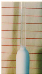
図 4 安定な透明化に成功した母材：下は多孔質母材，上は透明化した部分 Fig. 4 Transparent preform (upper part) after the consolidation process in He gas atmosphere.
