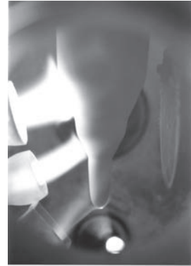
図 2 多孔質母材成長の様子：下のバーナからコア材，上二つのバーナからクラッド材が供給されている
