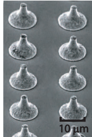
図2 先鋭バンプの例：コーン形バンプ Fig.2 Cone bump of compliant bump.
