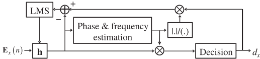
図 7 キャリヤ位相推定と適応等化の協調動作を行う信号処理回路
