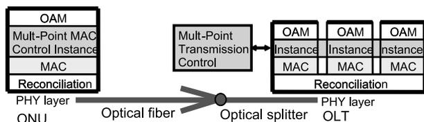
Fig. 5 Data link layer of GE-PON.
